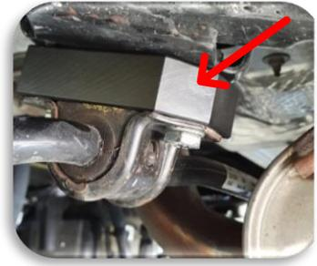
4. Die Koppelstangen nun in Stabilisator und Achse einbauen, (auf das Gewinde etwas Loctite auftragen) und festschrauben.
