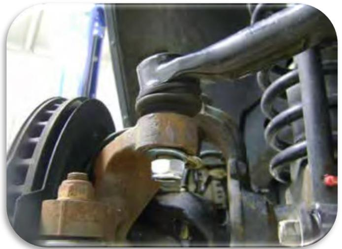
Wenn alles Passend ist nun die Große Schraube (SW22) mit der Beiliegenden Hülse und je nach Passform einer Beiliegenden Scheibe Ansetzen, danach Den Bügel mit den beiliegenden 3/8" 2 Muttern ansetzen, danach Festziehen.
